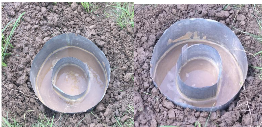
图 5.3.6-2 双环渗水试验现场照片
