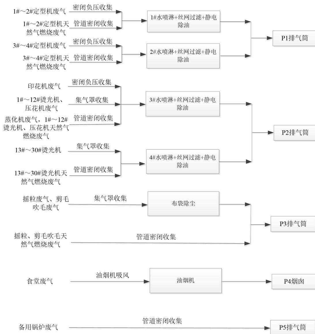
图 7.1.1-1 本项目有组织废气收集 - 处理路线图
