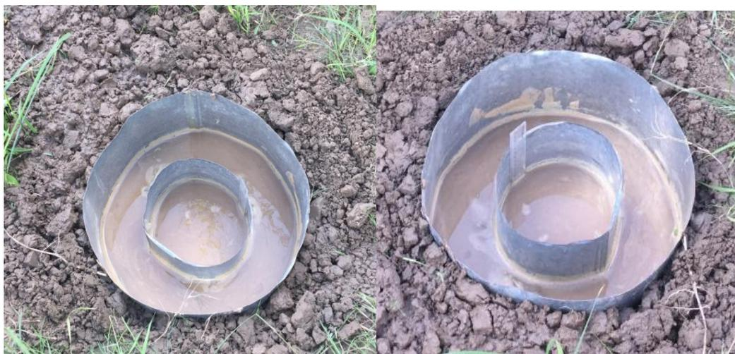
图 5.3.6-2 双环渗水试验现场照片
